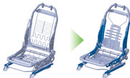
超高張力鋼板採用部品(青色部分)の変遷
